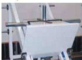
負荷用プレートラックは5力所
